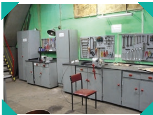
Места для хранения упорядочены по предназначению инструментов, снабжены этикетками и цветовой разметкой
