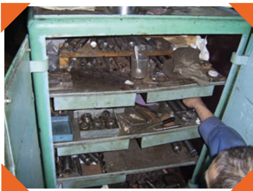
Ящик для хранения инструментов неудобен – низкие и глубокие полки заставляют приседать или нагибаться и искать «на ощупь»
